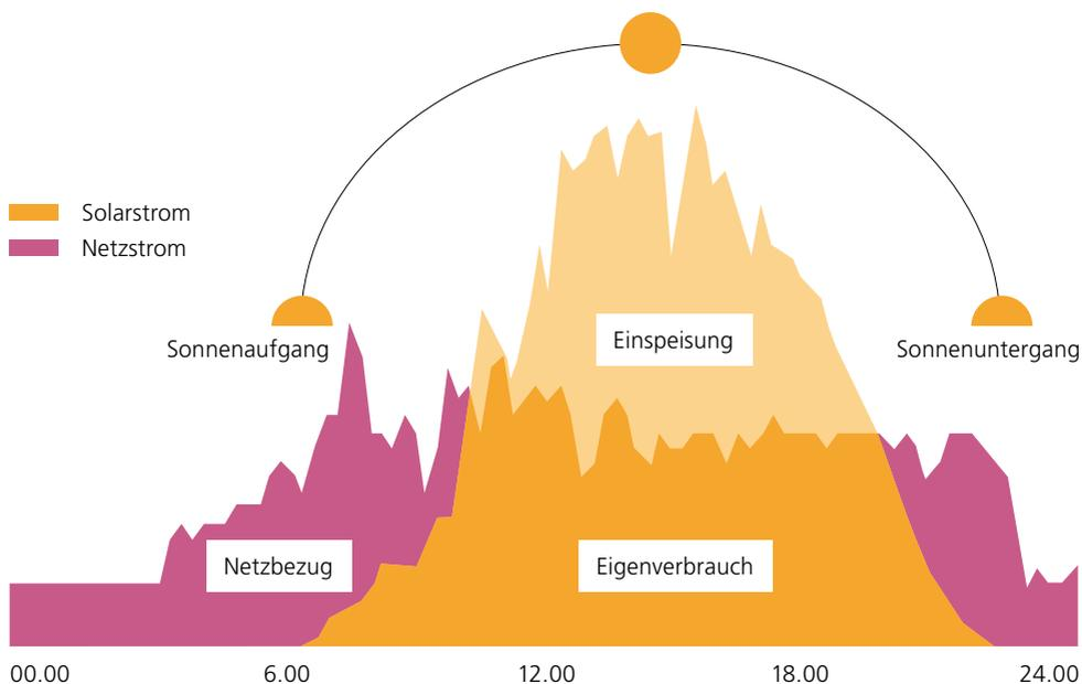
Die Grafik zeigt den Tagesverlauf einer Solaranlage mit Eigenverbrauch. Der produzierte Solarstrom wird entweder direkt innerhalb der Immobilie verbraucht (Eigenverbrauch) oder ins Netz eingespeist (Einspeisung). Zusätzlicher Bedarf wird mit Strom aus dem Netz gedeckt (Netzbezug).
