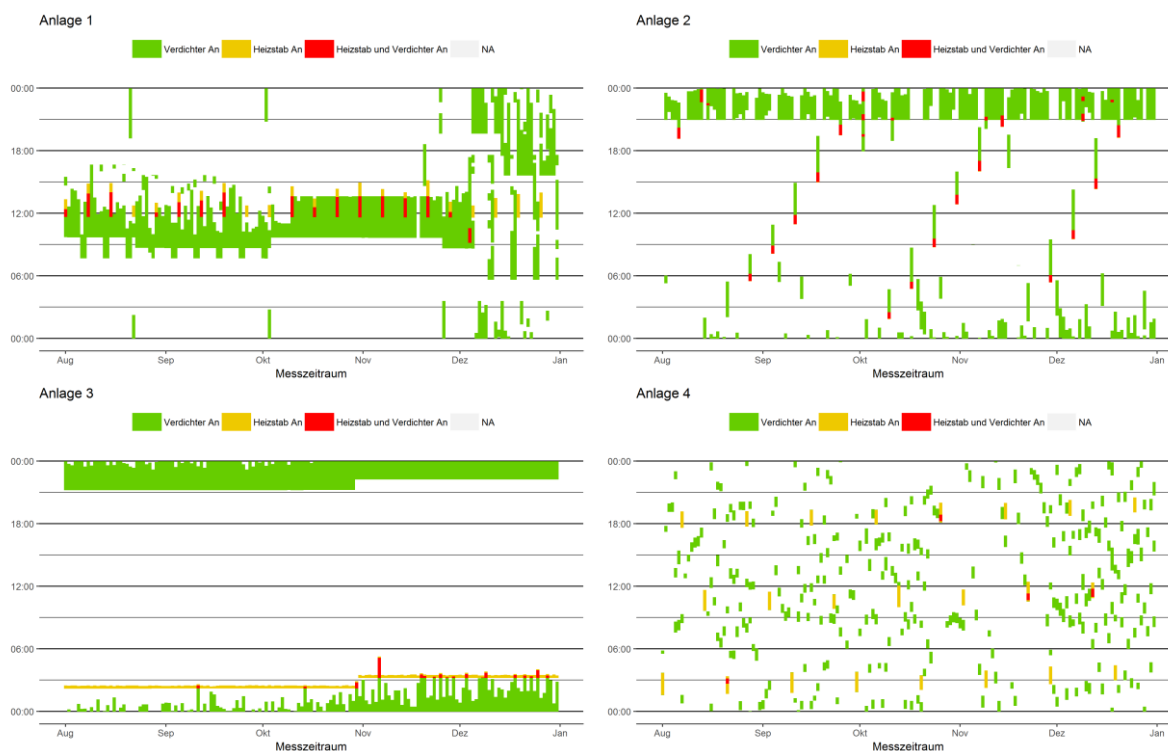
Abbildung 4: Zeitlicher Verlauf des Betriebes der Wärmepumpe und des Heizstabes in Anlage 1 bis 4
