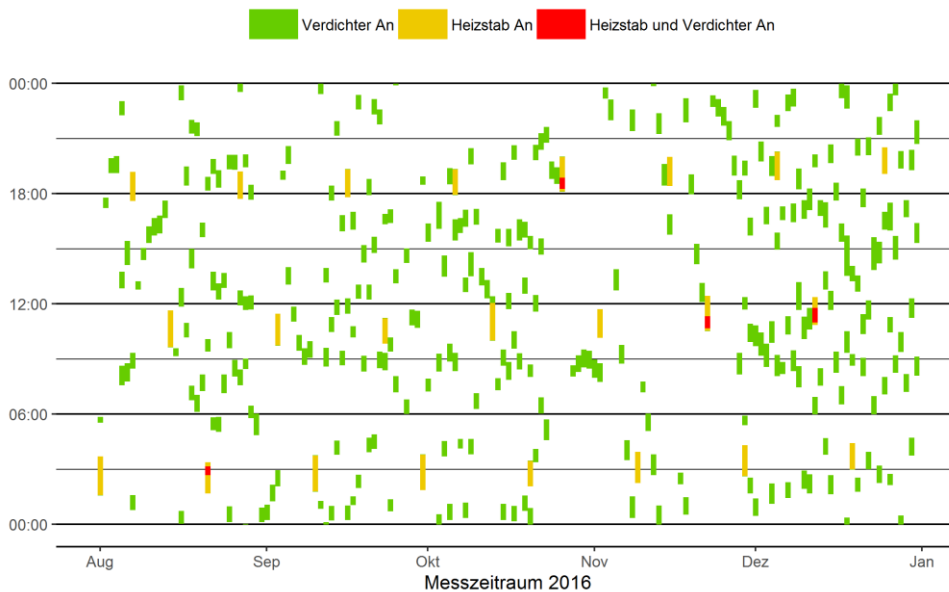
Abbildung 22: Zeitlicher Verlauf des Betriebes der Wärmepumpe und des Heizstabes in Anlage 4
