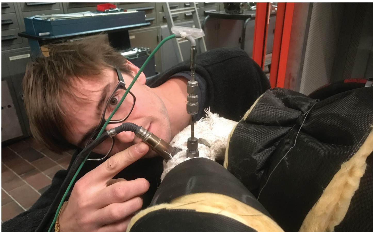
ETH-Forscher Christian Schürch mit der Laboranlage des Mikro-BHKW. Der Zeigefinger tippt auf die Lambdasonde, rechts davon ein Temperaturfühler zur Messung der Abgastemperatur. Foto: B. Vogel
