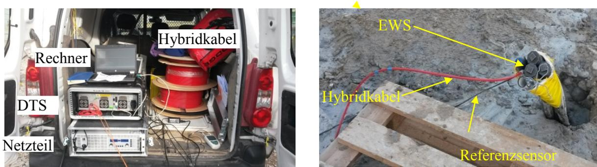
**Abb. 5:** Messaufbau (links) und EWS-Sondenrohr mit mobilem Hybridkabel (rechts), Beispielbilder
