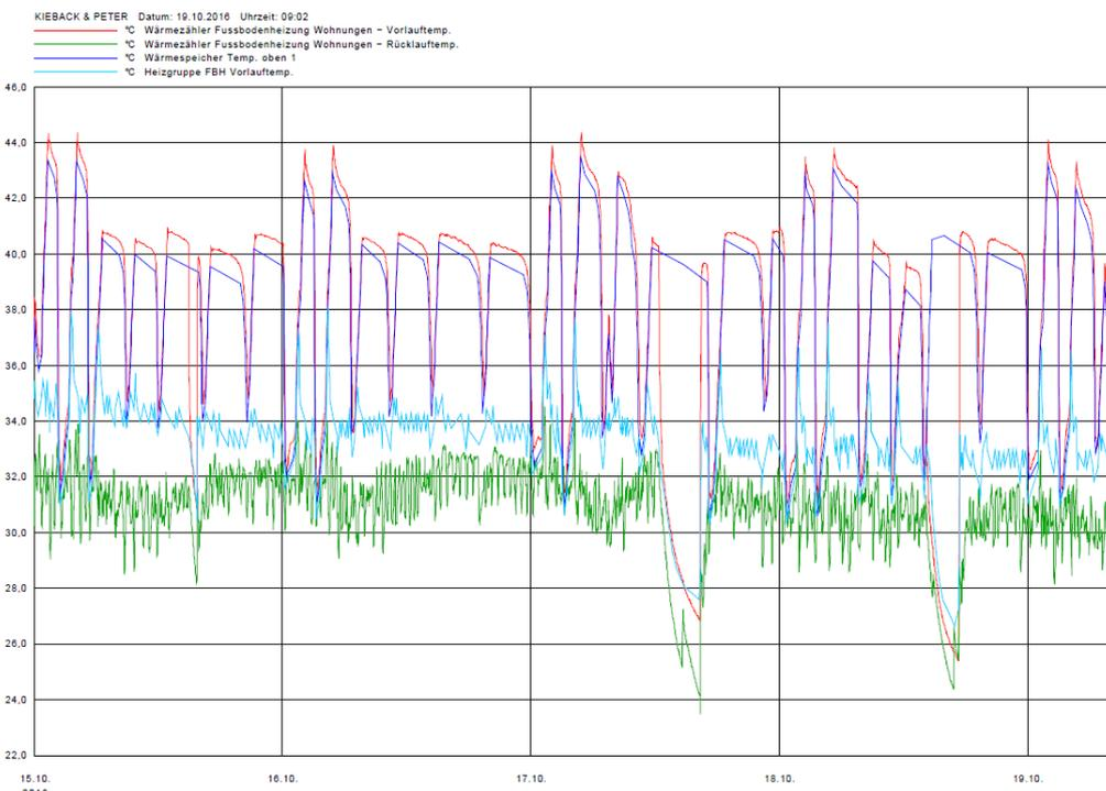
Abbildung 19: Darstellung Temperaturmessungen im Gebäudeleitsystem
