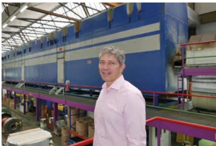
Markus Reber, Geschäftsführer von Metal Paint AG vor dem Lackierofen der Metal Paint. Die Abwärme aus der Nachverbrennung heizt heute die Zuluft für den Lackierofen auf 240 °C auf.
