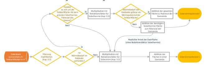
Abbildung 1: Ablaufschema zur Berechnung von Potenzial "Solarstrom 1" und Potenzial "Solarwärme"
