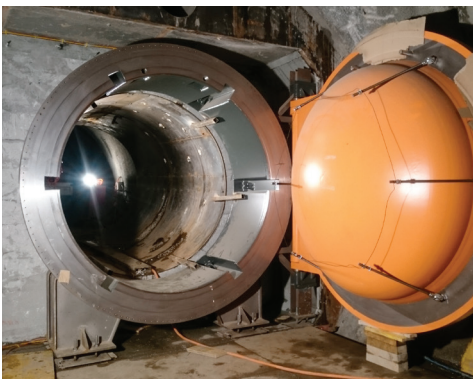
Die 7 Tonnen schwere Stahltür ermöglicht Forscherinnen und Forschern den Zugang zur Druckkammer.
