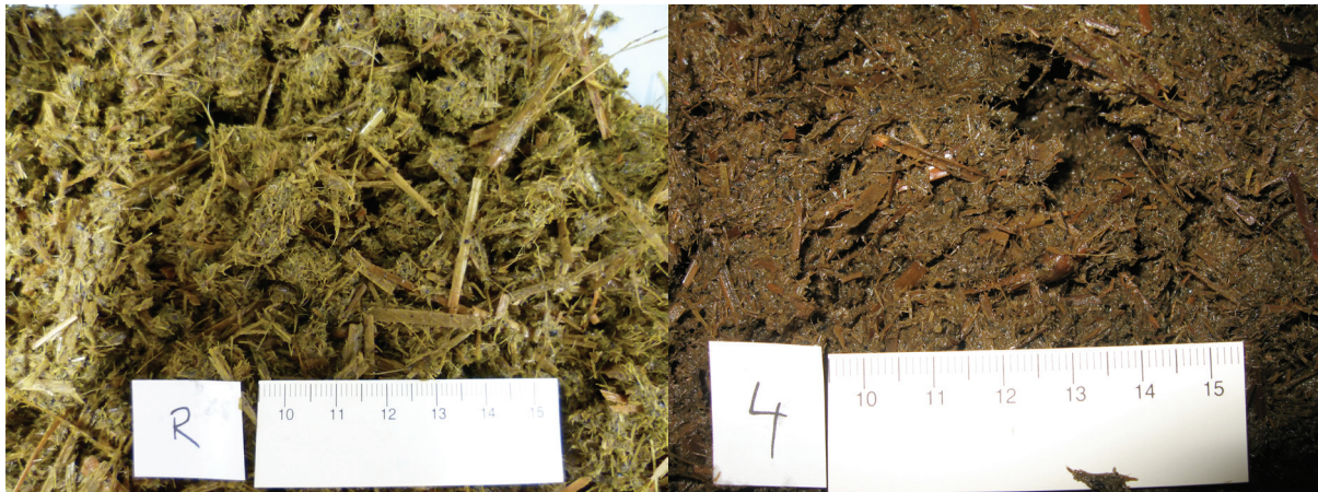
Güllefeststoffe unbehandelt (links) und nach einer Behandlung mit dem Dampfexplosions-Verfahren bei 150 °C und 15 Minuten Einwirkdauer (rechts). Foto: LEVER-Schlussbericht
