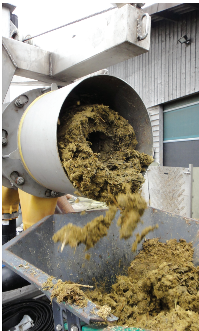
Rohgülle kann mit einer Siebpressschnecke in Dünngülle und Feststoffe (Foto) separiert werden. Siebpressschnecken haben einen geringen Energiebedarf und können als mobile Anlagen überbetrieblich eingesetzt werden. Foto: LEVER-Schlussbericht
