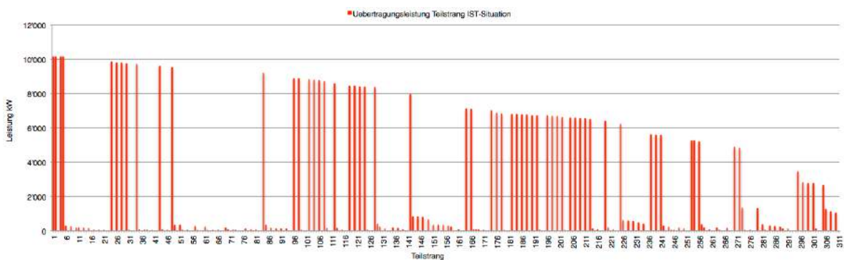
Bild 4.20 Übertragungsleistung der einzelnen Teilstränge im Fernwärmenetz.
