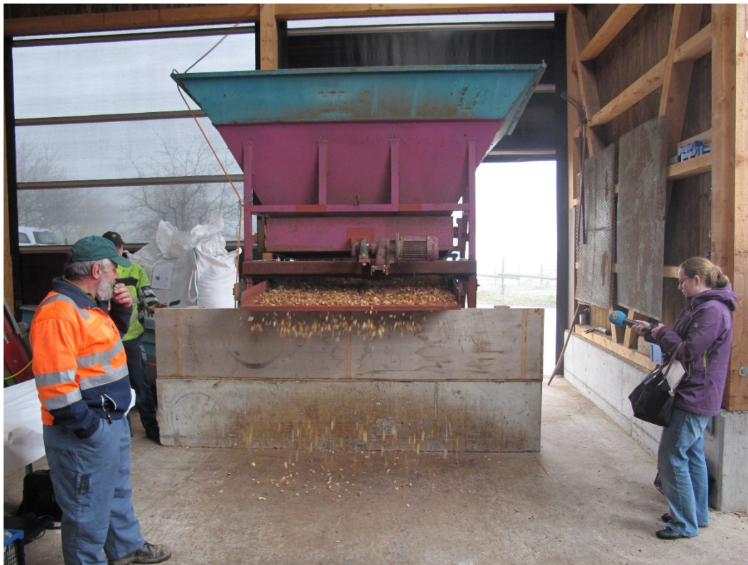
Abbildung 17: Rüttelsieb der Verora GmbH/NEAG im Wies in Neuheim ZG.
