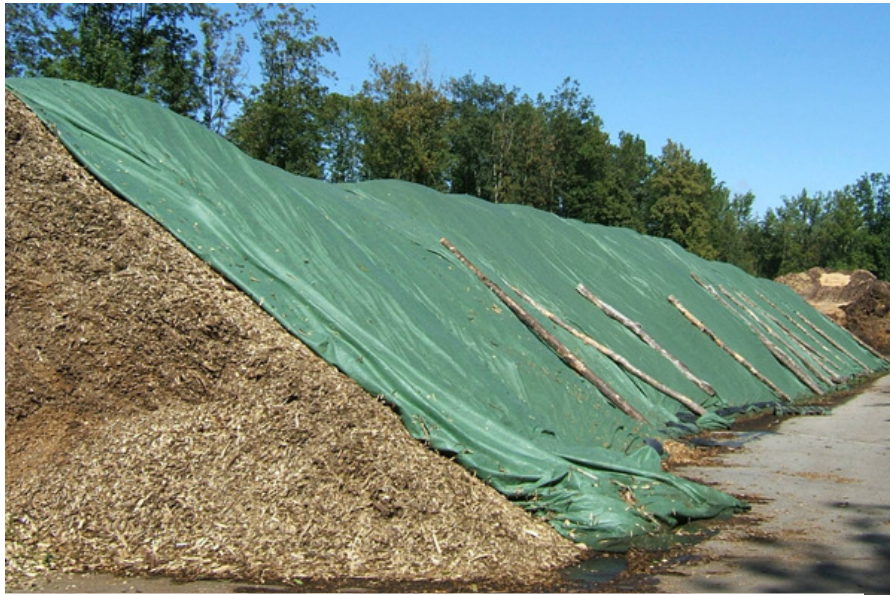
Abbildung 9: Ideales Freilager von Holzschnitzeln [15].
