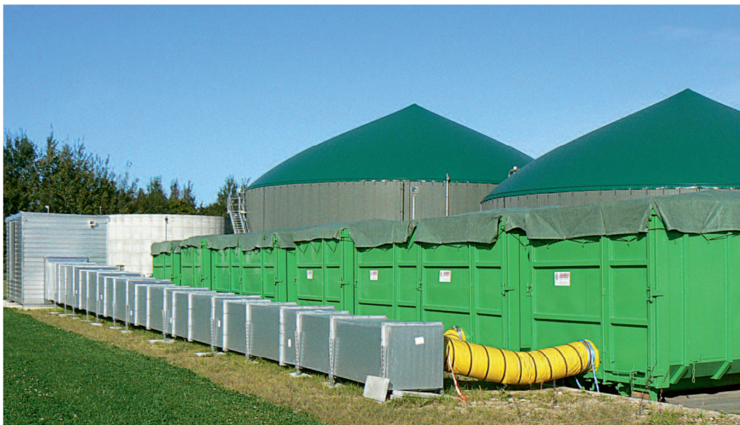
Abbildung 15: Containertrocknung mit Abwärme aus einer Biogasanlage [70].
