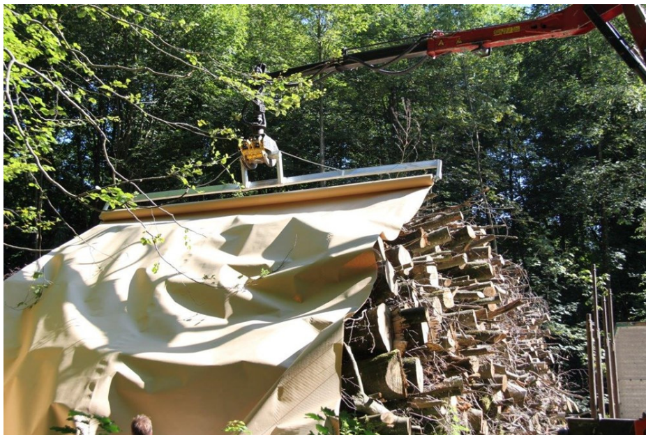
Abbildung 14: Abrollen der Abdeckfolie [4].
