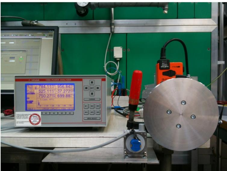
Abbildung 8: Messapparatur Dreh-Antriebe (im Vordergrund: Rotationsscheibe)
