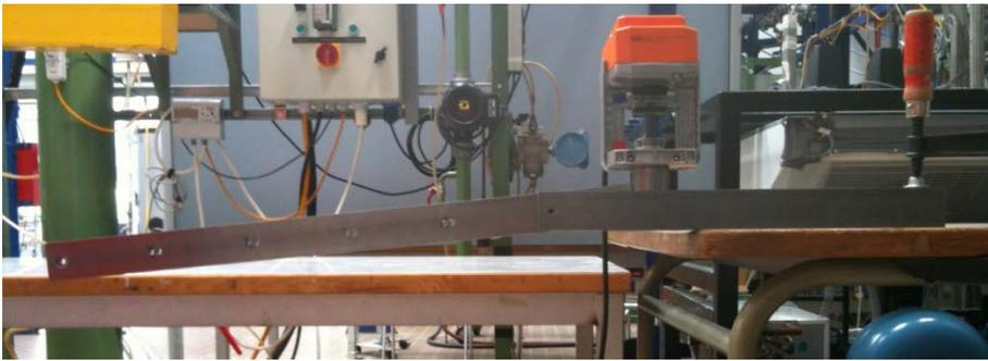
Abbildung 7: Messapparatur Hubventil-Antriebe
