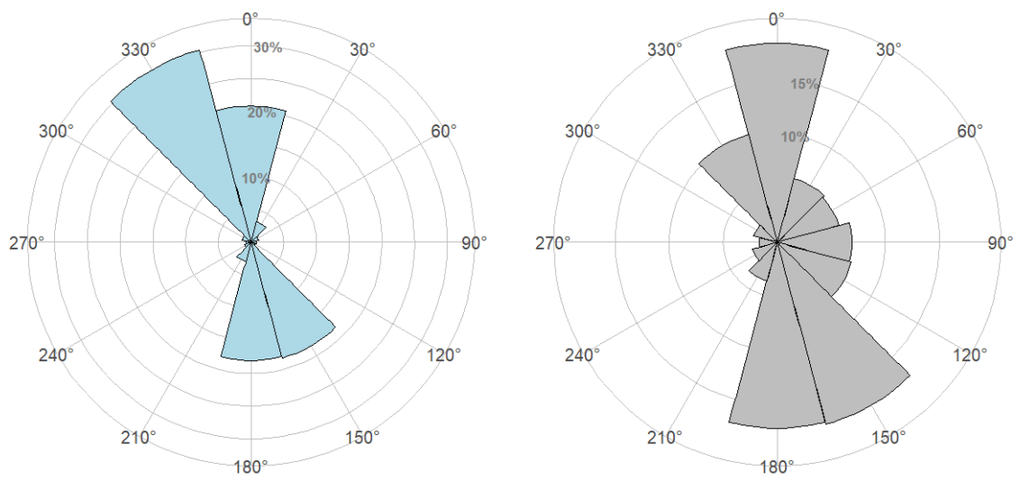
Abbildung 13: Vergleich einer Windrose einer Windmessung (links) und der modellierten Windrose (rechts) in den Alpen.
