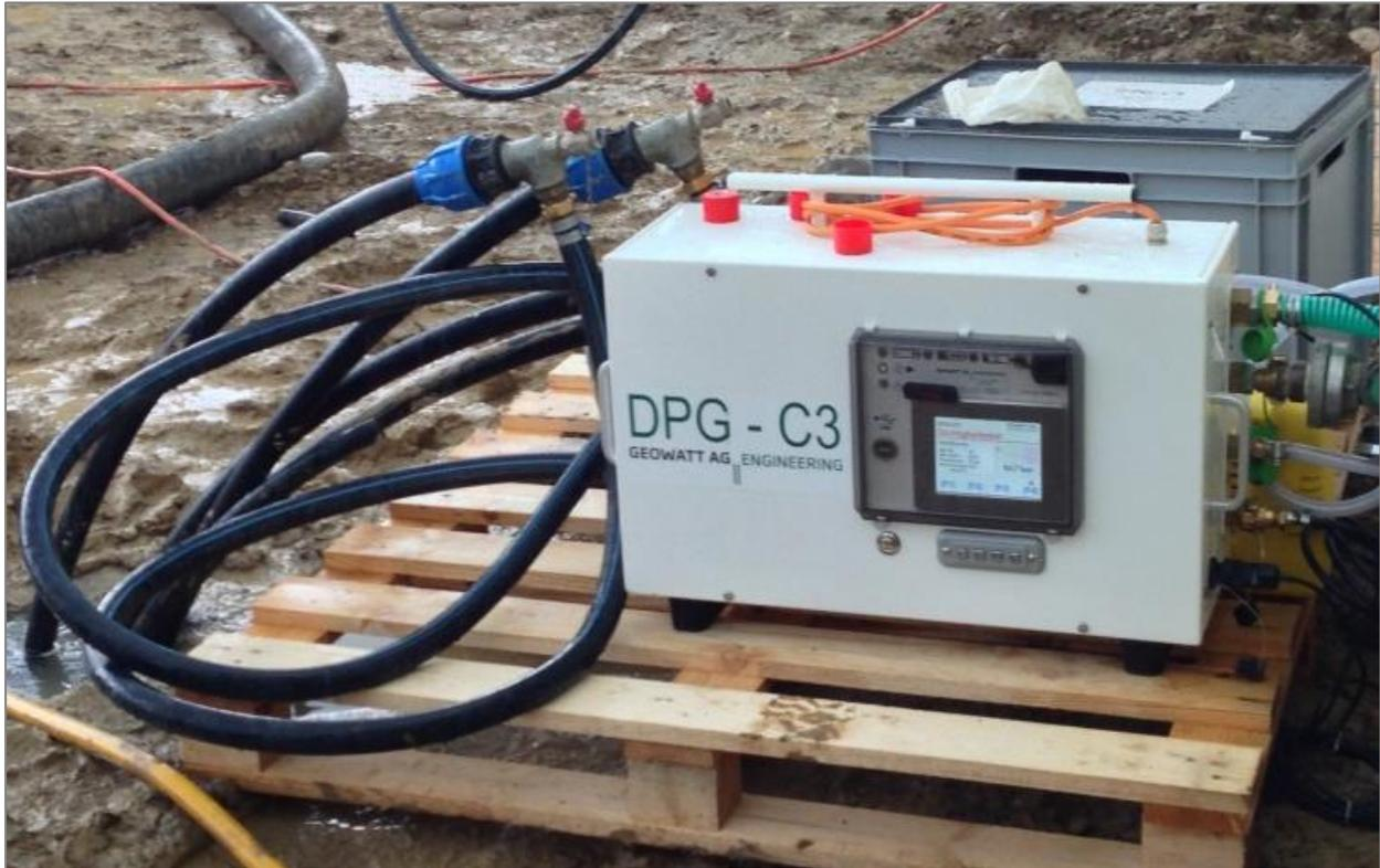
Figur 3-2: An eine EWS angeschlossenes Prüfgerät DPG-C3
