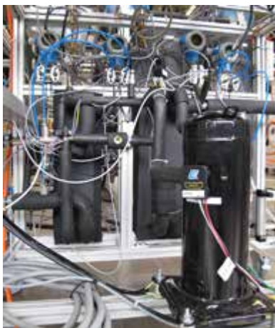
Bild 7: Leistungsgeregelter S/W-WP-Prototyp mit Inverter-Scroll-Kompressor (Emerson Copeland ZPV36) und Prüfstand „Wärmemodul“ im Labor der HSLU.
