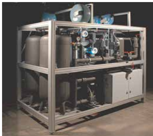
Bild 7: Leistungsgeregelter S/W-WP-Prototyp mit Inverter-Scroll-Kompressor (Emerson Copeland ZPV36) und Prüfstand „Wärmemodul“ im Labor der HSLU.
