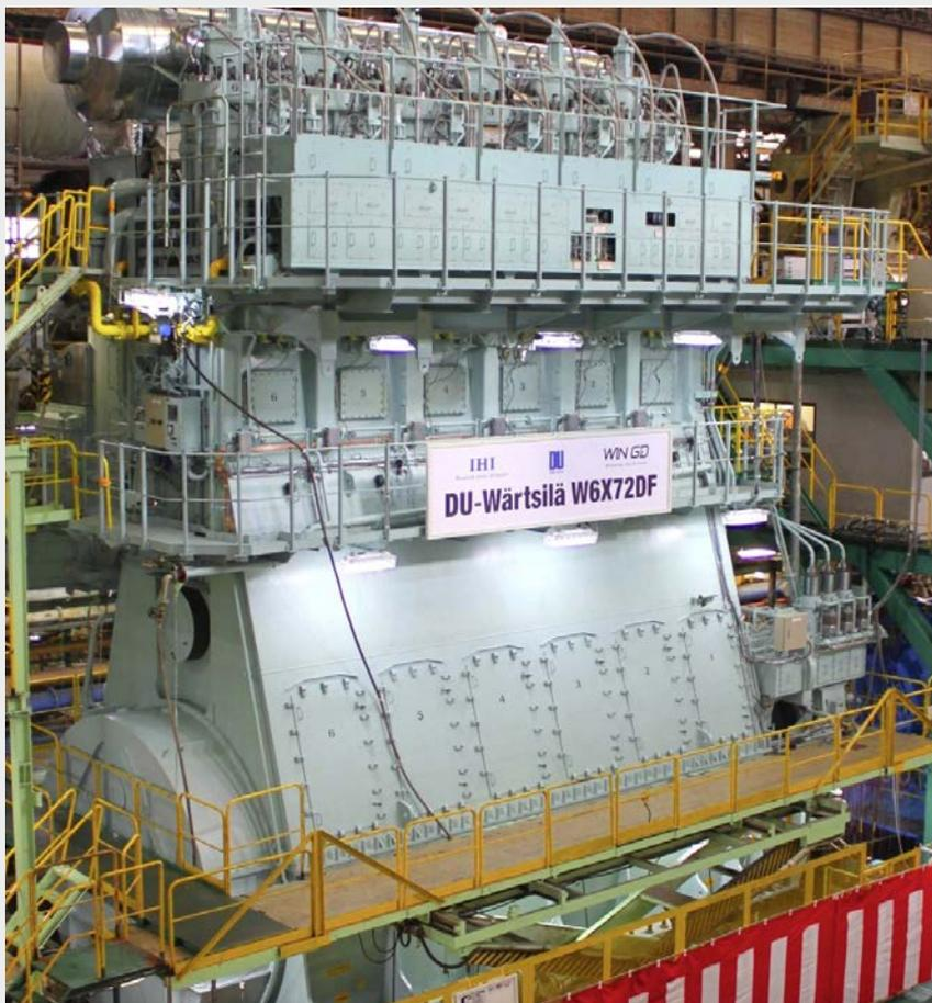
Fig. 4 Dual-Fuel-2-Takt-Versuchsmotor bei Winterthur Gas & Diesel in Winterthur (Bild: WinG&D)
