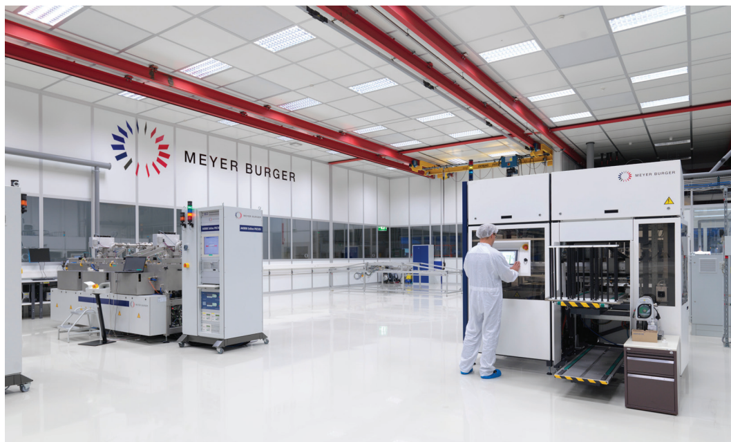
In einer Pilotfabrik in Hauterive (NE) werden seit 2014 hocheffiziente Solarzellen hergestellt, welche eine Verbindung zwischen Dünnschicht-Technologie und den klassischen Silizium-Zellen eingehen. Foto: Daniel Hager/CSEM-Meyer Burger
