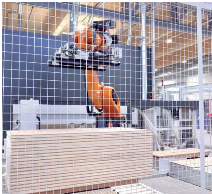
Roboter der vollautomatischen Fertigungsstrasse im Neubau der Türenfabrik Brunegg AG.
