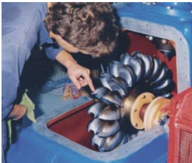
Die Pelton turbine des Kraftwerks Aegerta.
