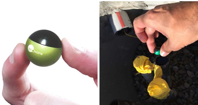
Abbildung 3: Links: Das miniaturisierte kugelförmige Temperatur- und Druckmessgerät GEOSNIFF (Quelle: Enoware) Rechts: das Messgerät im Einsatz (Quelle: GEOTEST)
