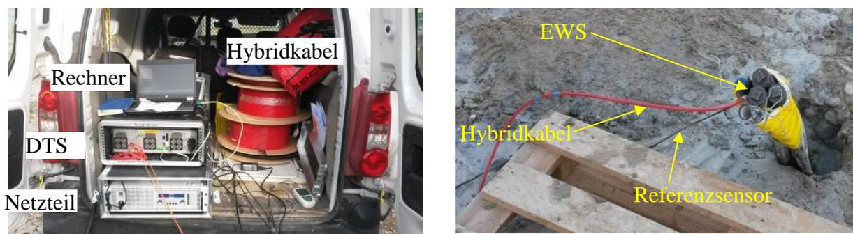
**Abb. 6:** Messaufbau (links) und EWS-Sondenrohre mit Hybridkabel (rechts)
