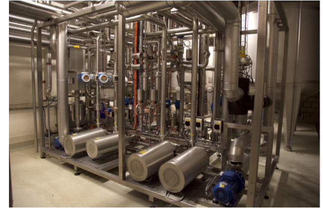
Versorgung der Kurzzeiterhitzungsanlage für Bier in Tankfahrzeugen und der Eiswasseranlage zur Versorgung des Technikums.
