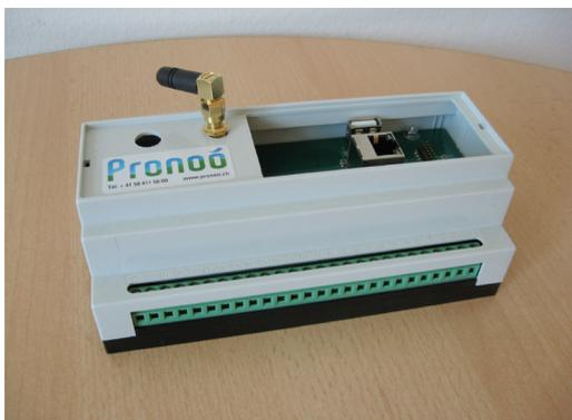
Der EcoGateway wird im Heizungsraum installiert und dient dort als Schnittstelle, an welcher die mit Wetterprognosen errechneten Korrekturwerte auf die Heizungsregelung übertragen werden. Foto: Pronoó
