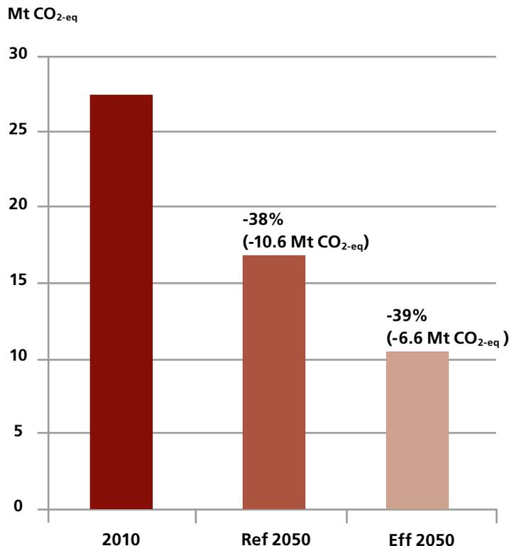
Die Entwicklung der Treibhausgas-Emissionen (THGE) unter denselben Annahmen. Die deutlich stärkere prozentuale Abnahme der THGE gegenüber dem Energiebedarf entsteht durch die Überlagerung der Effizienzsteigerungen und der Umstellung auf erneuerbare Energie. [1 Mt CO<sub>2-eq</sub> = 1 Megatonne Treibhausgase, umgerechnet auf CO<sub>2</sub>; 1 Mt = 1 Million Tonnen]
