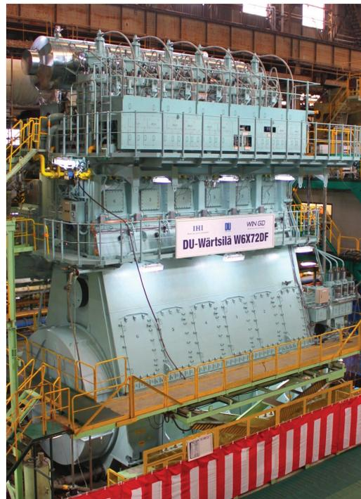
*Dual-Fuel-2-Takt-Versuchsmotor bei Winterthur Gas & Diesel. Foto: WinG&D*
