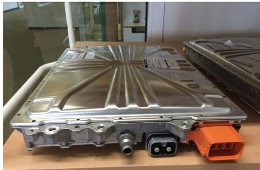
Ladegerät dieses Typs mit 22 kW Leistung werden zum Beispiel in den Elektro-Smart eingebaut. Foto: B. Vogel
