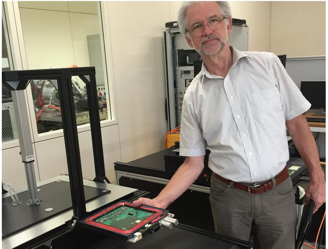
*Pilot einer induktiven Ladestation für E-Mobile: Firmenchef Josef Brusa zeigt die kleine Platine, die in den Unterboden des Autos eingebaut wird. Foto: B. Vogel*
