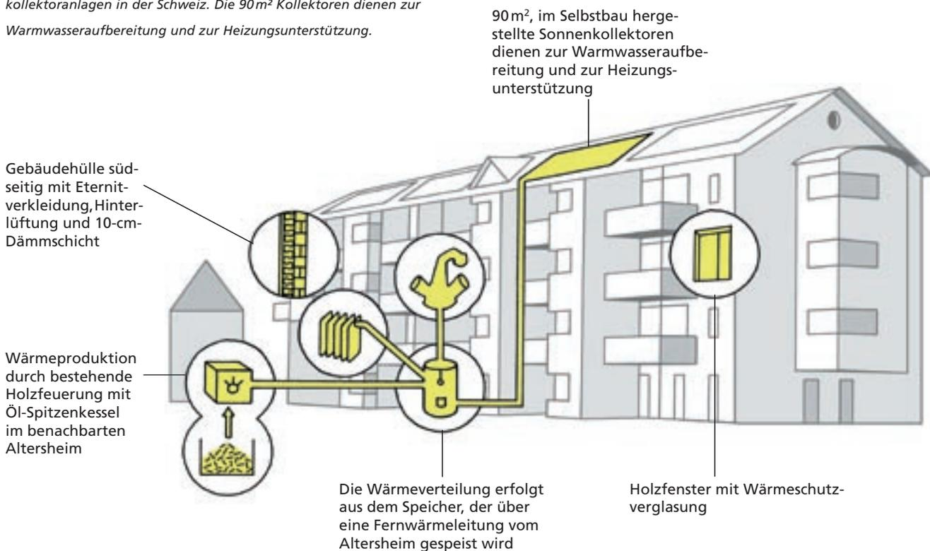
Heizungswirkungsgrads. Momentan sind die Wärmeverluste der Warmwasser-Zirkulation noch zu hoch. Die Zirkulation ist von 5 Uhr morgens bis nachts um 22 Uhr in Betrieb und «fährt» dementsprechend hohe Verluste ein. Allein der Energiebedarf für die Zirkulation beläuft sich auf  $\frac{1}{3}$  des Verbrauchs für die gesamte Warmwasseraufbereitung. Die Druckverhältnisse in den Verteilungen werden neu «eingestellt», um die Widerstände bei der Wärmeverteilung zu vermindern.
