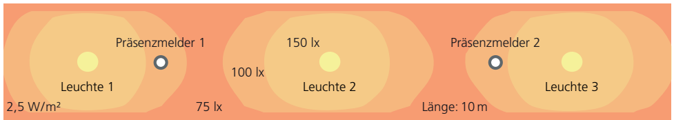
Grundriss eines Korridors mit Leuchten und Isolux-Kurven
