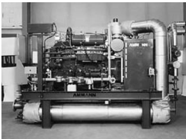
Das Blockheizkraftwerk erzeugt aus Biogas Strom und Wärme.
