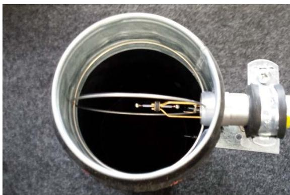
Abbildung 26: Messung der Luftgeschwindigkeit
