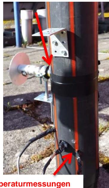
Abbildung 25: Messaufbau in der Entlüftungsleitung
