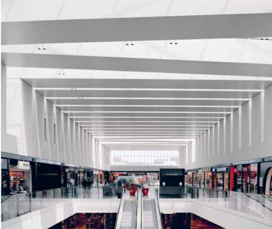
Abbildung 60: Zusammenspiel zwischen Gebäudehülle und Energiekonzept am Beispiel von Migros Marin. Dank der grosszügigen Raumhöhe und einem intelligenten, natürlichen Belüftungssystem – es nutzt die Thermik und die verschiedenen Druckverhältnisse – kann auch in den heissen Sommermonaten ohne zusätzliche Kühlenergie ein angenehmes Raumklima garantiert werden (Quelle: Sorane).
