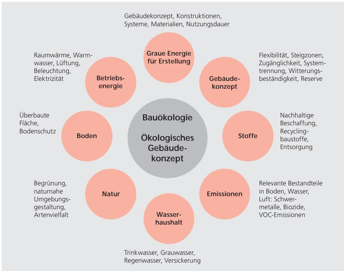
Abbildung 4: Übersicht der bauökologischen Aspekte. Bauökologie ist eng verknüpft mit dem ökologischen Gebäudekonzept, bei dem die Weichen in einer frühen Planungsphase gestellt werden. Aspekte der Betriebsenergie und der Natur werden in diesem Buch nicht behandelt (Quelle: eco-bau).
