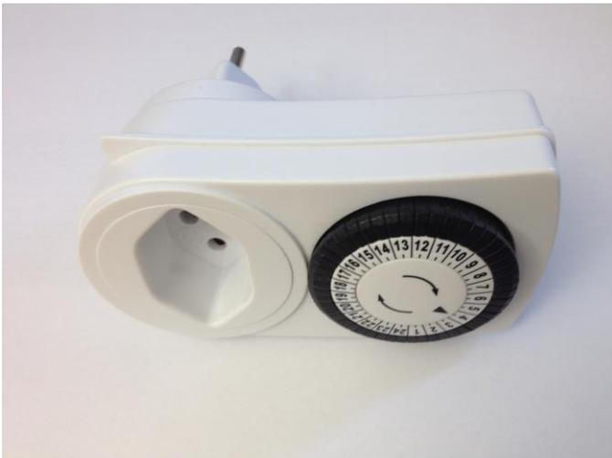
Bild 3: Mechanische Schaltuhr: Diese weist einen Verbrauchswert von ca. 1,0 Watt auf (Bild: R. Brüniger AG)
