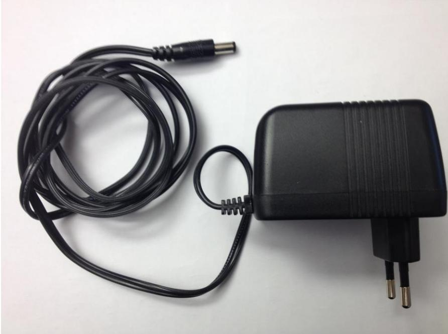
Bild 1: Altes, schweres Modem-Netzgerät: Dieses weist (gemessen) einen Standby-Wert auf von ca. 1,5 Watt
