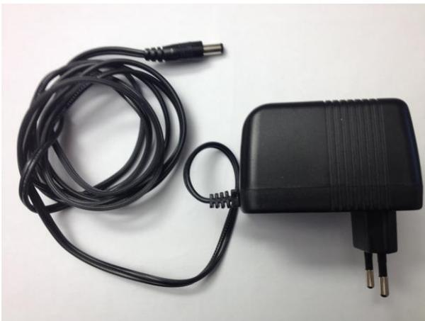
Bild 1: Altes, „schweres“ Modem-Netzgerät: Dieses weist (gemessen) einen Standby-Wert von ca. 1,5 Watt auf (Bild: R. Brüniger AG)
