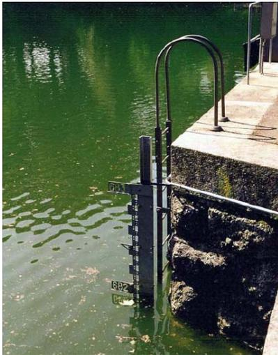
**Abbildung 9: Lattenpegel zur Wasserstandsmessung**
