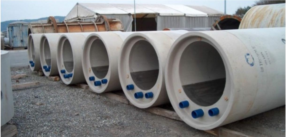
**Abb. 6:** Vorfabrizierte Kanäle mit Wärmetauscher, Quelle: ecoquent-positions, 28.04.2015
