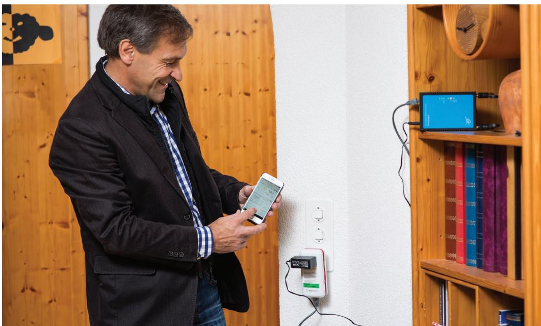
tiko-Nutzer Willi Aggeler hat in seinem Eigenheim in Landquart (GR) eine sogenannte M-Box (das weisse Gerät in der Steckdose) installiert. Die M-Box macht es möglich, dass die Swisscom Energy Solutions AG von Olten aus per Mobilfunk-Signal Aggellers Wärmepumpe und Elektroboiler ein- und ausschalten und damit Regelenergie generieren kann. Foto: Pierre Oettli
