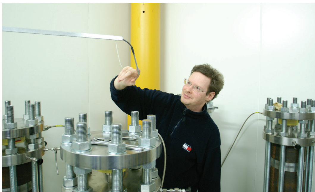
Dr. Cyrille Dunant in seinem Labor an der Eidgenössisch Technischen Hochschule in Lausanne. Dunant zeigt auf den Temperaturfühler, der sicherstellt, dass im Raum konstant eine Temperatur von 38 °C herrscht. Foto: B. Vogel
