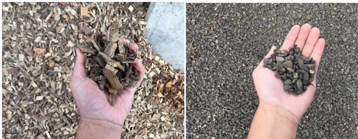
Quelle: amtradeco, Aufnahmen im Aufbereitungslager in Muttenz. Bild der Holzchnitzel (Buchenholz mit Rindeanteil), links und Bild der Palmkernschalen, rechts
