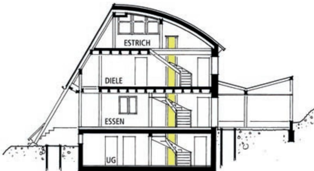
Querschnitt durch das Gebäude, grün der Geröll-Wärmespeicher.
