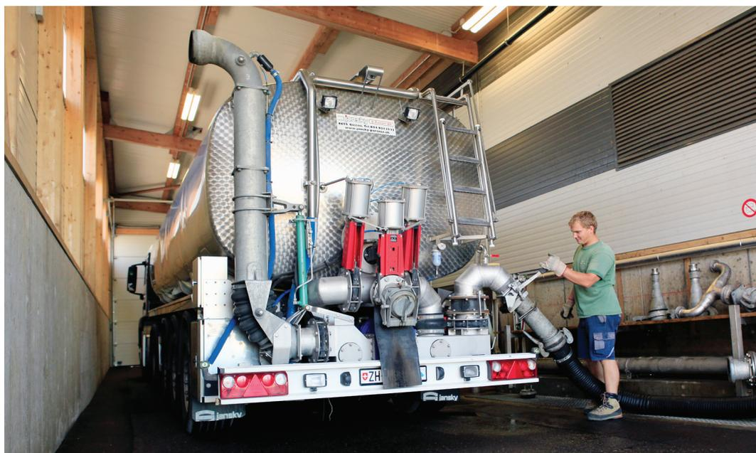
*Die Vorbehandlung der Substrate (im Bild: Anlieferung flüssiger Substrate in einer Biogasanlage) sind ein wichtiges Thema in der aktuellen Biomasse-Forschung. Foto: SFPI*
