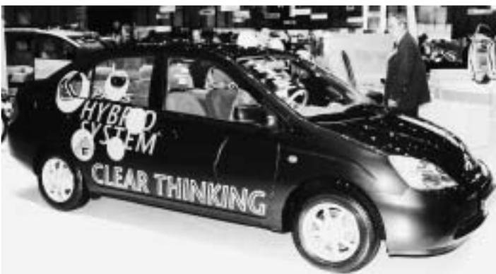
**Der Toyota Prius ist das erste serienmässige Hybrid-Auto. Mit einem kombinierten Benzin-Elektro-Antrieb schluckt es im Schnitt um die 5 l/100 km.**
