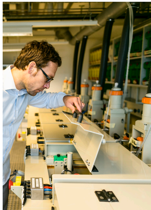
GreenTEG-Labor im Technopark Zürich: Das elektrochemische Abscheidungsverfahren ist die Kerninnovation bei der Herstellung thermoelektrischer Generatoren. Foto: Balz Murer
