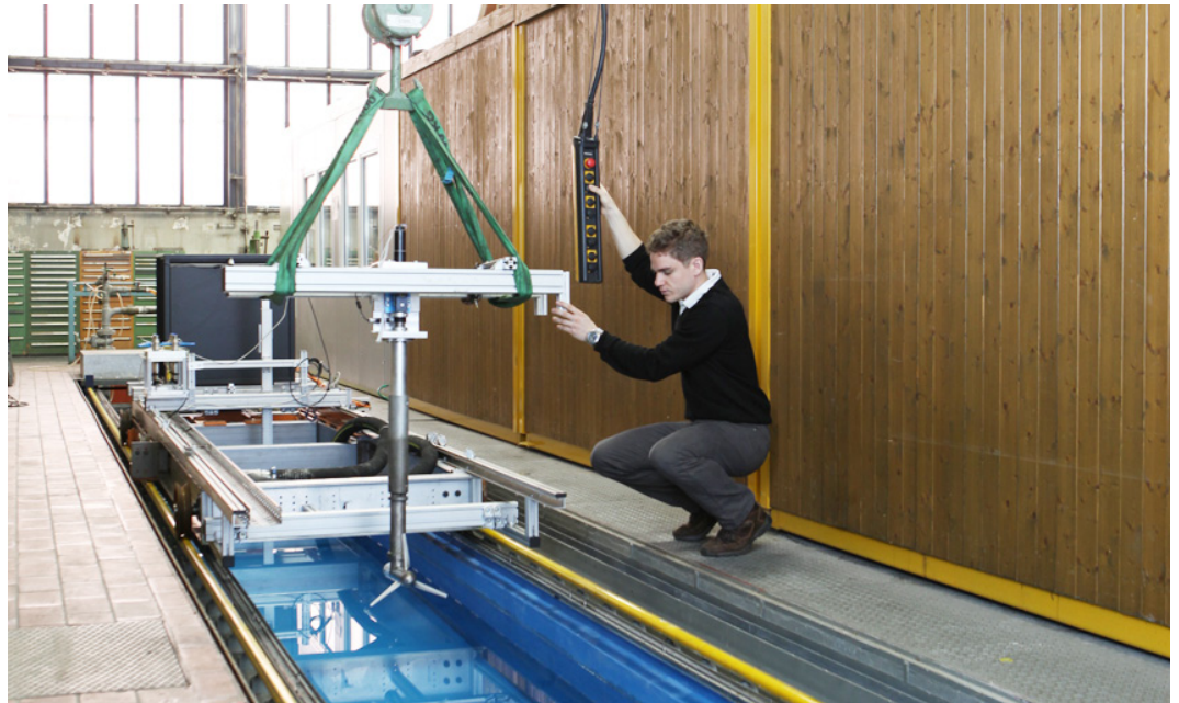
ETH-Forscher Christian Kress senkt die auf dem Kopf stehende, skalierte Windkraftanlage – bestehend aus Rotor, Gondel und Turm – in den Wasserkanal der Versuchsanlage. Foto: ETHZ
