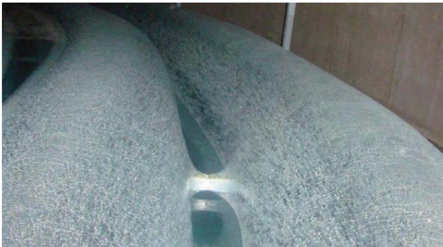
Abbildung 6: Eisbildung um die Wärmetauscherrohre eines Rohrbündelwärmetauschers (Viessmann, 2012)
