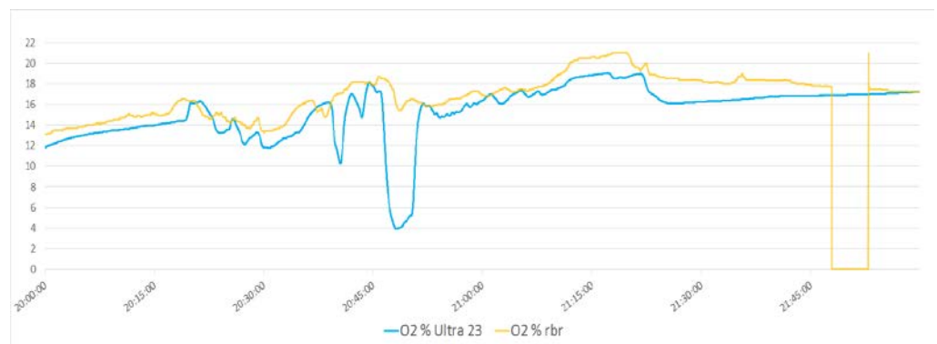
Bild 13: Vergleichsmessung rbr J2KN contra Ultramat 23 vom 29.09.2013 Anlage 09-2013 (1Messwert pro Sekunde): O 2 in %
