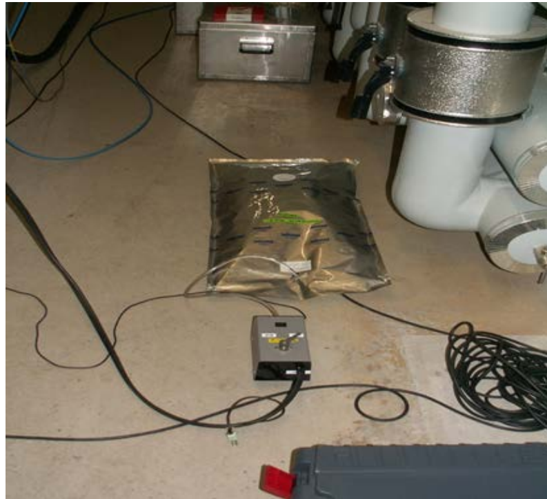
Bild 5: Gassammelsack und Absaugpumpe (anapoli) für die Geruchmessung
