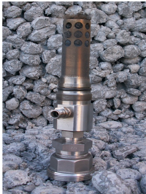
Filter der beheizten Sonde einer schlechten Anlage (schwarz)
