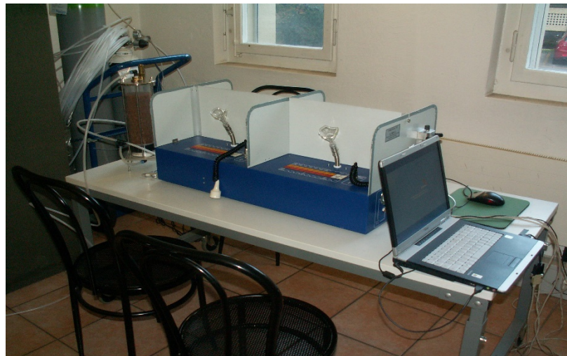
Bild 6: Olfaktometrische Einrichtung (Olfaktometer) für die Geruchmessung mit kalibrierten Probanden (KBP NaturUmweltVerkehr, 3007 Bern)
