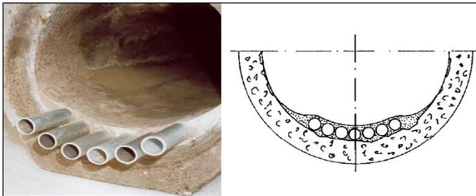
**Abb. 20: Rohrwärmetauscher**
