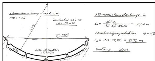
Abb. 8: Dimensionierungsskizze des WT in Basel Bachgraben
