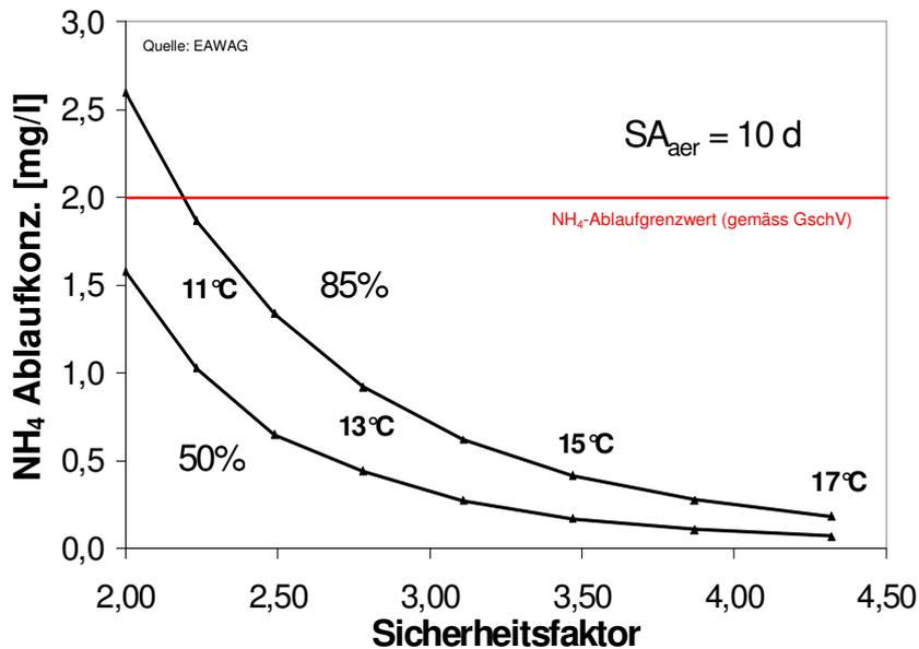
Abb. 13: NH<sub>4</sub>-Konzentration im Ablauf der Nachklärung in Abhängigkeit vom Sicherheitsfaktor SF (50%- und 85%-Lasttag)
