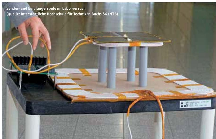
Sender- und Empfängerspule im Laborversuch
