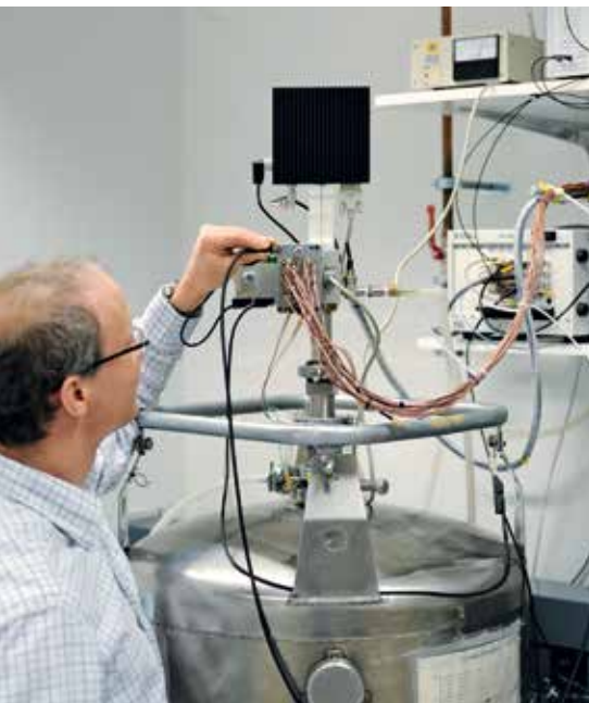
Installation zur Messung des Josephson-Effekts im Labor von METAS.
