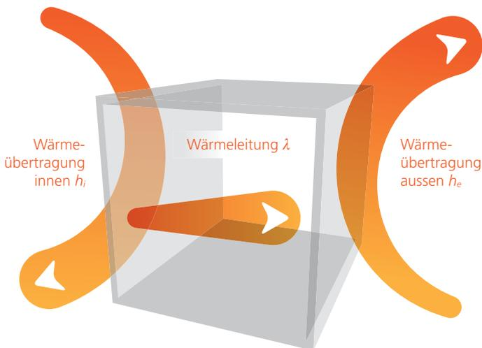
Wärmeübertragung ( $h$ ) und Wärmeleitung ( $\lambda$ ) beeinflussen den U-Wert von Bauteilen
