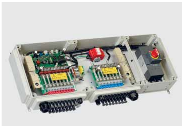
Abbildung 48: Generatoranschlusskasten für Solar- kabel mit Sicherungen, Überspannungsableiter, Strangüberwachung und Gleichstromhaupt- schalter (SMA Solar Technology AG).
