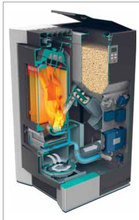
Abbildung 132: Schnitt eines Pellets- ofens mit integriertem Pelletsbehälter (Rika).
