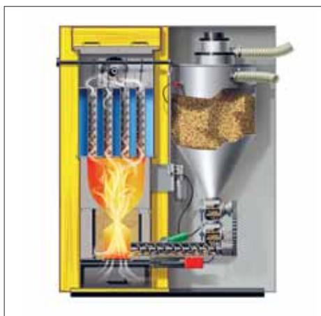
Abbildung 137: Schnittbild Pellets-kessel mit Zwischenbehälter (Hargassner).
