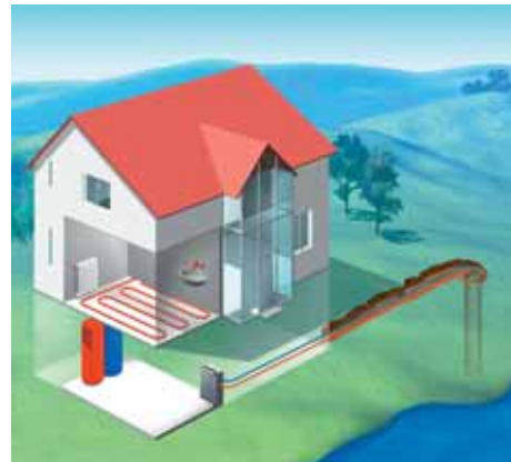
Abbildung 101: Prinzip einer Erdwärmesonden-Wärmepumpe.
