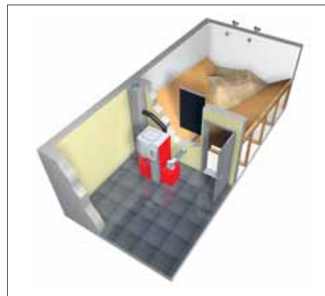
Abbildung 135: Pelletsessel mit direkter Beschickung über Schnecke ab Brennstofflager (Hargassner).
